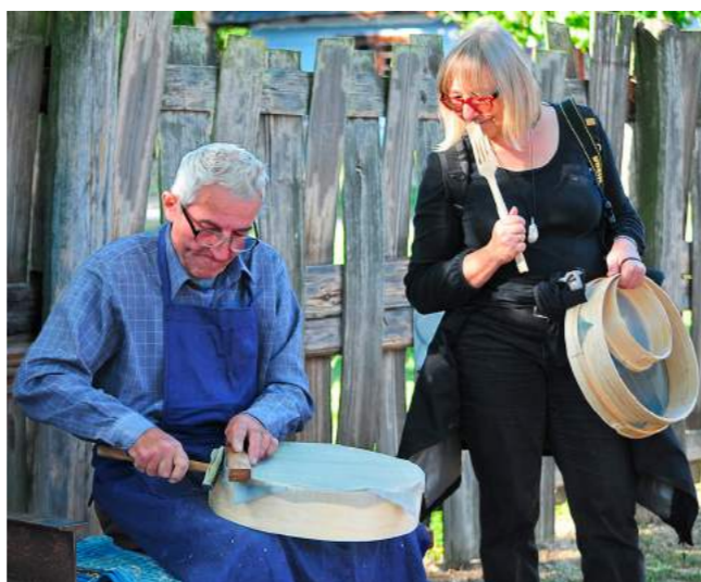
Sitarz w skansenie mocuje metalową siatkę w sicie.
